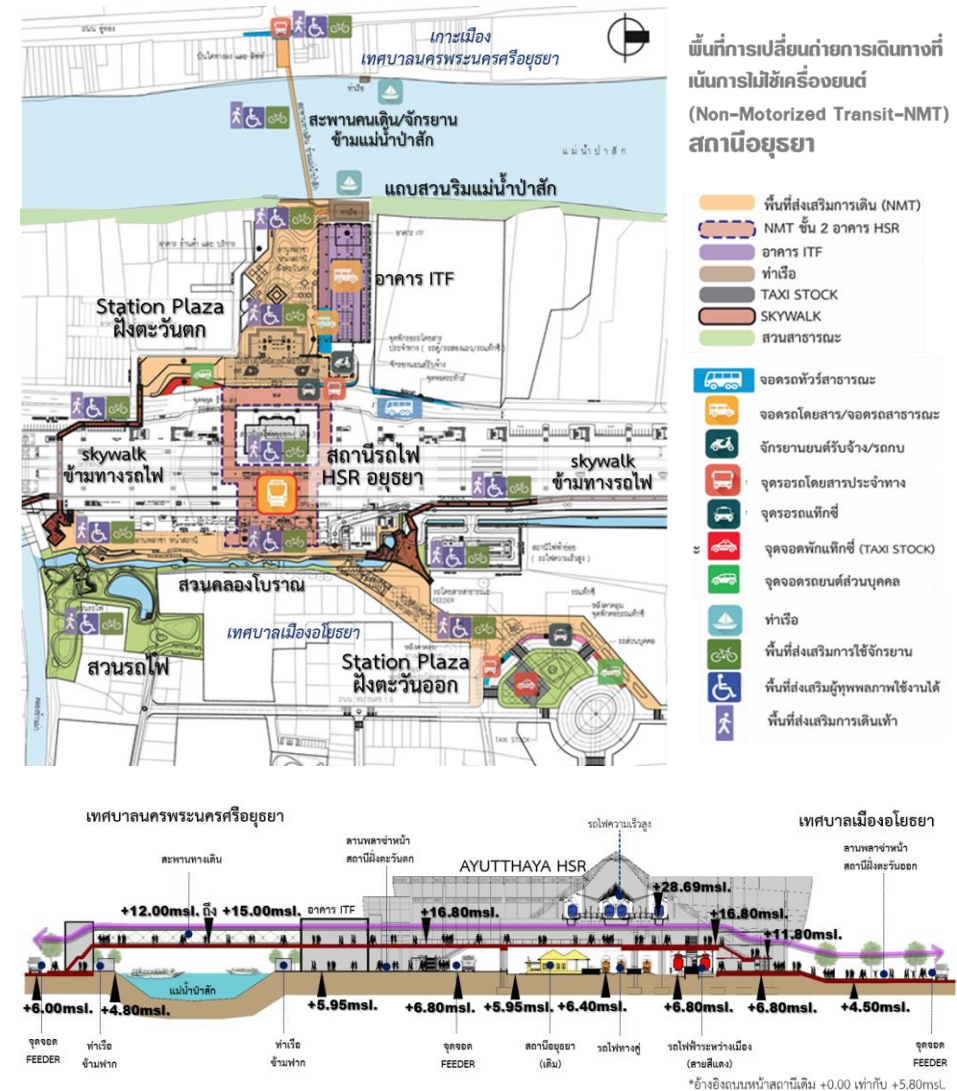
รูปที่ 17 พื้นที่การเปลี่ยนถ่ายการเดินทางที่เน้นการไม่ใช้เครื่องยนต์ (Non-Motorized Transit : NMT) ของสถานีอยุธยา
